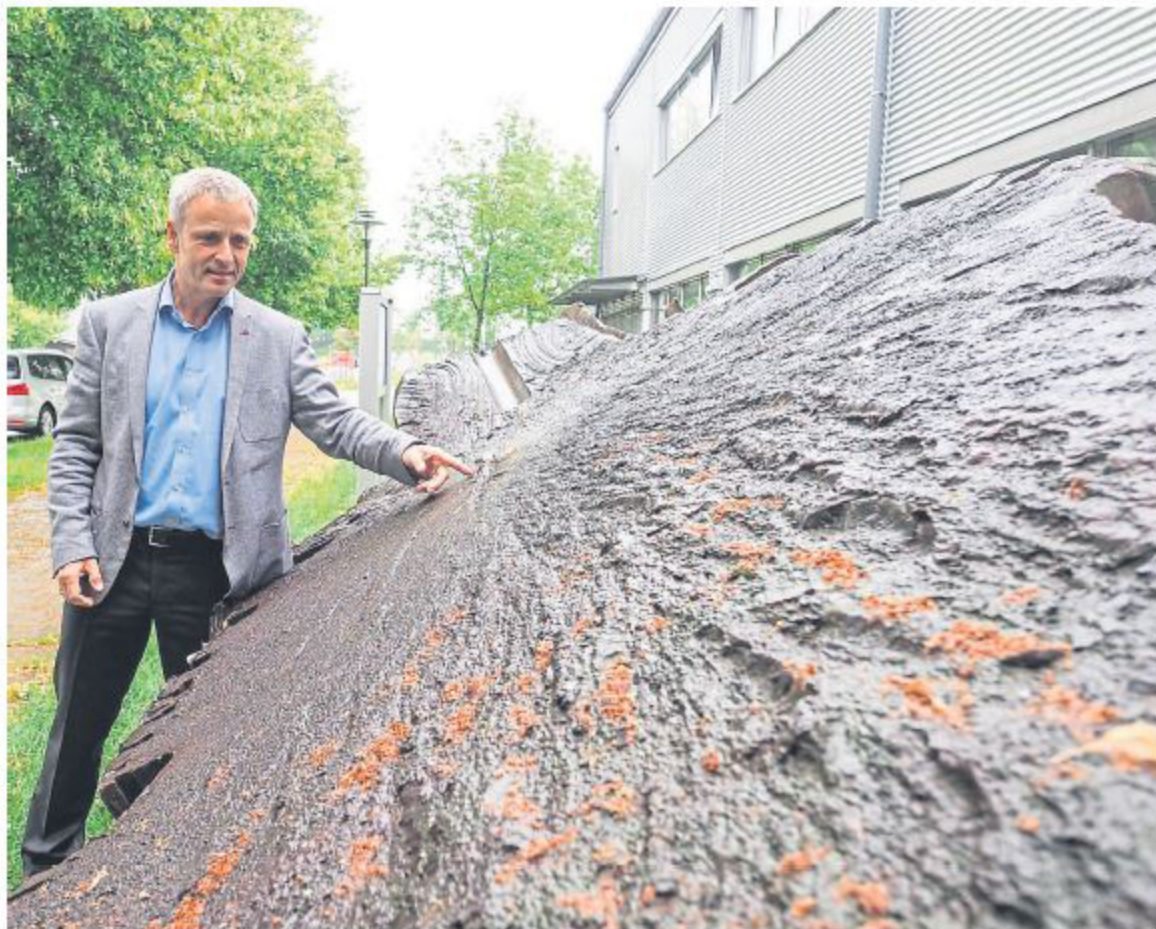
Eine geborstene Getriebewelle, die Irschingwelle, vor dem Laborgebäude mit Johannes Stoiber (AZT). Das Teil zählt zu den größten metallischen Brüchen weltweit.
